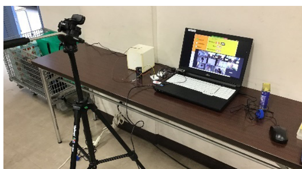
図-6 リモートスマハキットの設置状況:三脚に取り付けたWebカメラから、建物模型のLEDが光る様子を確認できる。
