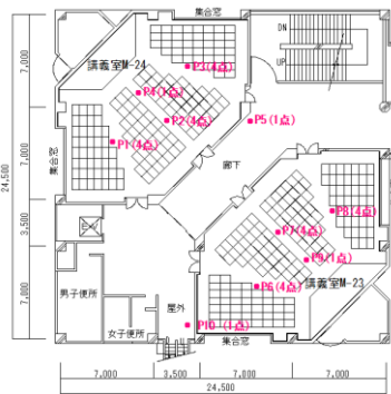
図-2 測定器の設置場所
