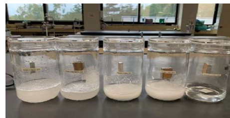
写真1 広口ガラス瓶を用いた平衡含水率測定
