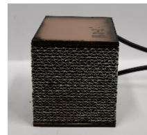
図-1 測定用除湿エレメントの実写（銅箔電極）
