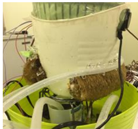
写真-2 除湿冷却器
