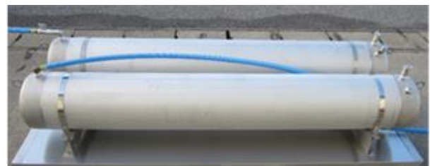
図-8 2槽の給水タンク
