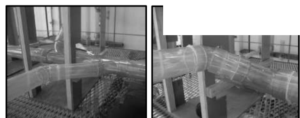
I : 立ち上げなし II : Y 継手部立ち上げ ii (図 1、図 2 中) 供試排水トラップ付近
