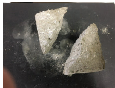
図-3 炭酸カルシウム25%の40cm落下後
