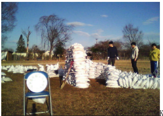
図-3 17段の途中で崩れてしまった様子
