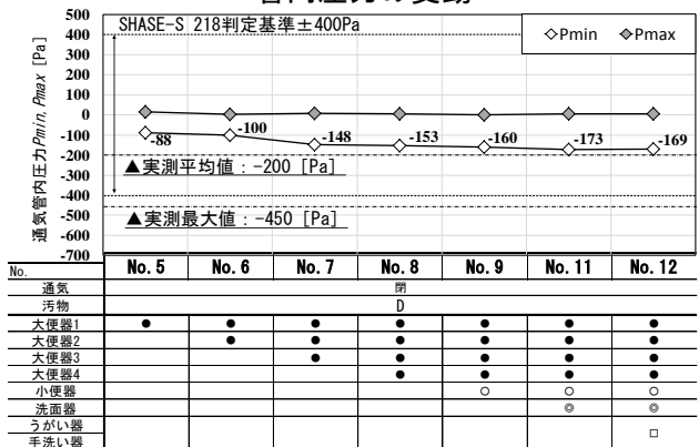
図9 排水横枝管内合流排水実験における器具数別管内圧力の変動
