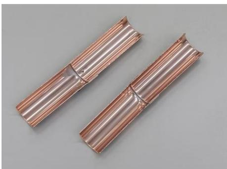
写真-4 局所窒素置換工法でろう付した配管内面
