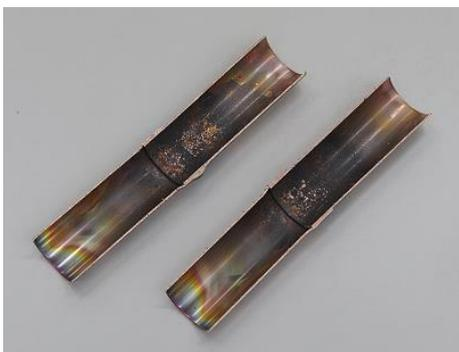
写真-5 酸化防止策せずに行うろう付した配管内面
