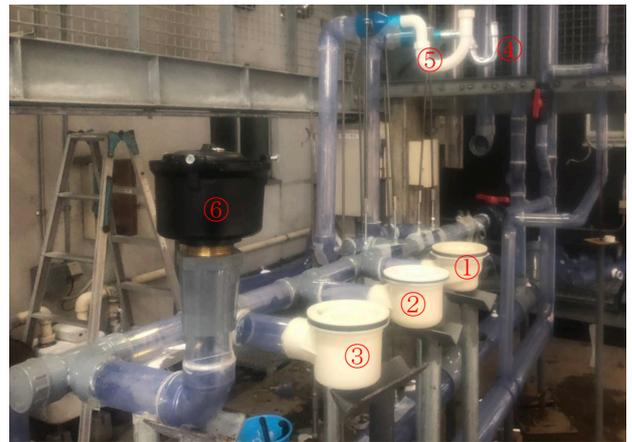
写真-1 供試排水横枝管システム
