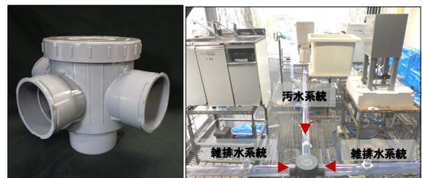
写真-1 供試多口管継手
